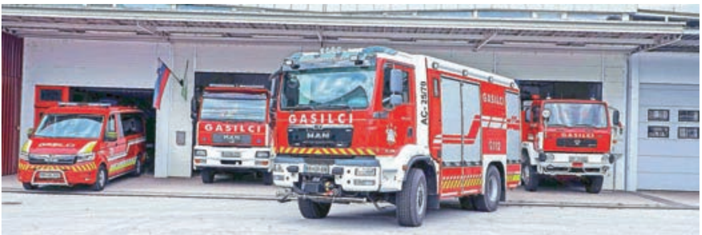
Vojni park PGD Železniki na čelu z novo pridobitvijo – avtocisterno AC-25/70 z maksimalnim pretokom vode 2500 litrov na minuto in kapaciteto rezervoarja za sedem tisoč litrov vode. Investicija v novo vozilo je vredna med 270 in 280 tisoč evri.
